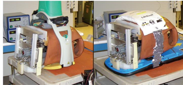
Abbildung 1: Kolbenbewegtes (links) und Kompressionsbandsystem (rechts) an der kalibrierten Versuchspuppe.
