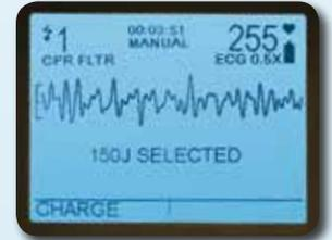
Les filtres See-Thru CPR éliminent les artefacts de la compression sur l'ECG, réduisant ainsi le temps sans compressions et permettant de vérifier si un rythme organisé et traitable par choc s'est établi.
