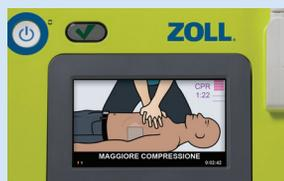
Real CPR Help® assiste il soccorritore nell'esecuzione di una RCP di alta qualità, fornendo un feedback in tempo reale sulla frequenza e sulla profondità della compressione toracica.
