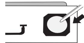
5. **Inserte el segmento inferior del montaje del accesorio de entrada del compresor en el dispositivo y asegúrese de que su pasador de alineación se acople.**
