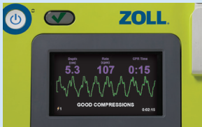
CPR Dashboard™ ของ ZOLL แสดงข้อมูลความลึกของ CPR อัตรา และระยะเวลา เป็นตัวเลขแบบเรียลไทม์
