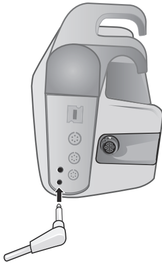
Figura 12-1 Conexión de la sonda de temperatura a la unidad X Series Advanced
