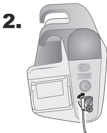
Figura 9-1 Conexión del conector de la línea de muestreo al puerto de entrada de CO 2
