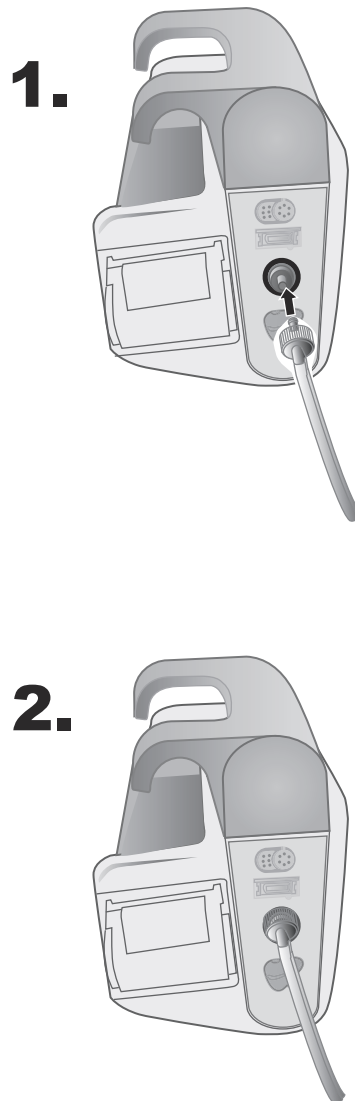
Figura 8-1 Conexión de un tubo de luz dual a la unidad X Series Advanced
