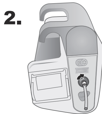
Figura 8-2 Conexión de un tubo de luz individual a la unidad X Series Advanced
