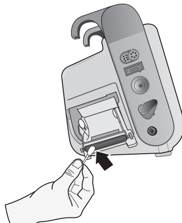
Figura 26-3. Limpieza del cabezal de impresión
