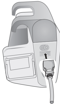
Figura 10-3 Conexión del sensor de SpO 2 a la unidad X Series Advanced
