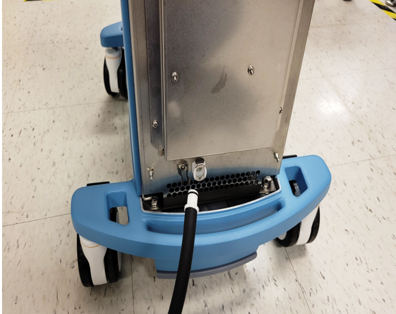
Figure 7.3. Pousser le tuyau dans le raccord de vidange
