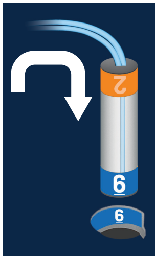
Figure 4.41. Introduire le piège à bulles dans la chambre
