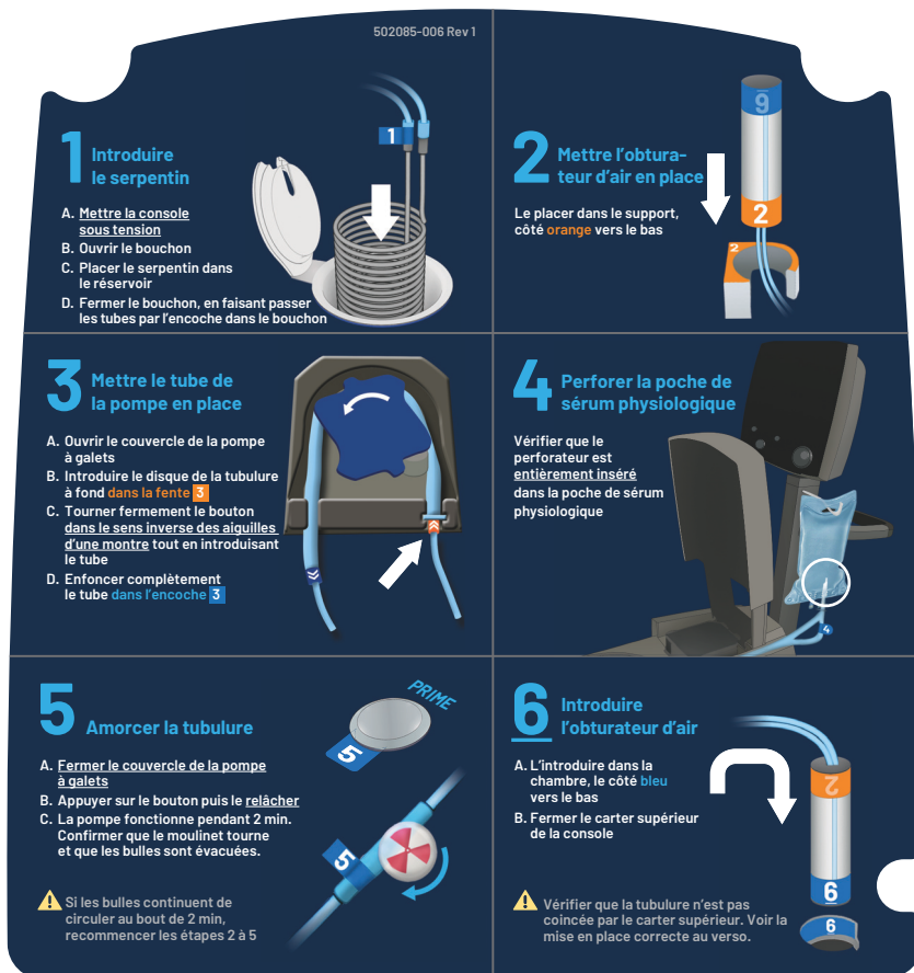
Figure 2.7. Guide d'installation sous le carter de la console
