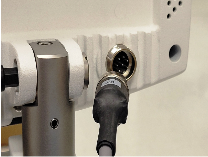
Figure 3.5. Brancher le câble de commande dans la prise
