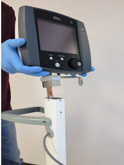
Figure 3.3. Fixer la tête d'affichage à la colonne
