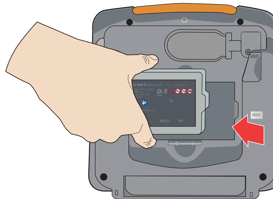
Retire la batería del AED 3 del embalaje de envío. Sostenga la batería por las lengüetas laterales, con la etiqueta hacia afuera. Coloque la batería en la parte posterior del DEA hasta que escuche un chasquido y la batería encaje en su lugar; alinee la muesca de la parte final de la batería con la forma correspondiente en el hueco de la batería.
