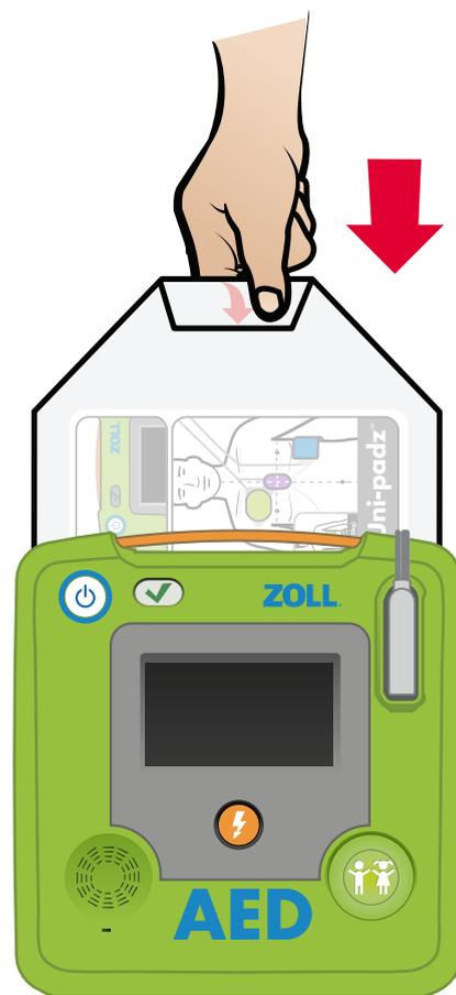
El ZOLL AED 3 realizará un autoanálisis automático. Mientras se está ejecutando el autoanálisis, inserte el CPR Uni-padz en la parte posterior del DEA de forma tal que la etiqueta del paquete apunte hacia usted.
