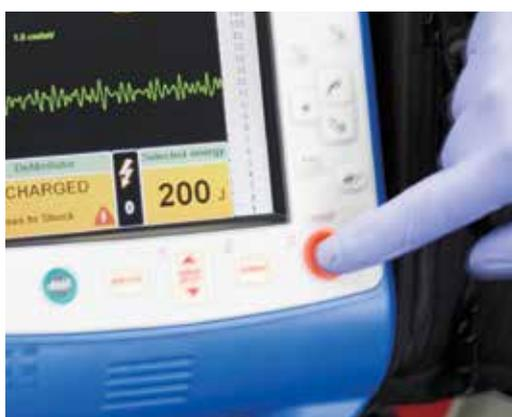
X Series® 在 AutoPulse® Plus 持續按壓過程中充電，確保在需要電擊時能迅速施行電擊去顫。
